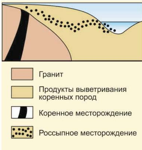
Рис. 50. Схема расположения россыпного месторождения
